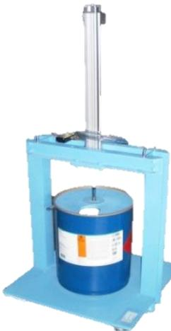
Förderpresse zum Verarbeiten von Silikonmaterial aus dem in einem Metallbehälter befindlichen Plastikbeutel. Behälter (20 Liter Eimer) wird auf die dafür vorgesehene Platte gestellt und an das System angeschlossen. Mittels Druckluftkolben wird das Silikon aus dem Beutel über das Dosiersystem auf das zu bestückende Teil aufgebracht.
