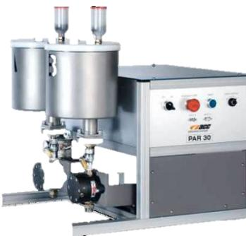
Zahnradtechnologie wird dann verwendet, wenn eine präzise genau festgelegte Menge konstant ausgebracht werden soll. Diese Anlagen können für lange Dichtschleifen oder Verguss- und Formenbauwerkstoffe eingesetzt werden. Die kleinen Tischgeräte können bis zu 2 Liter/Minute, die größeren Anlagen bis zu 4,8 Liter/Minute fördern.
