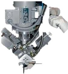
Für hochgefüllte Produkte wie das Silikon QSil553 kann es notwendig sein, automatische Rührsysteme in den Tanks einzubauen um Sedimentierung des Werkstoffs zu vermeiden.
